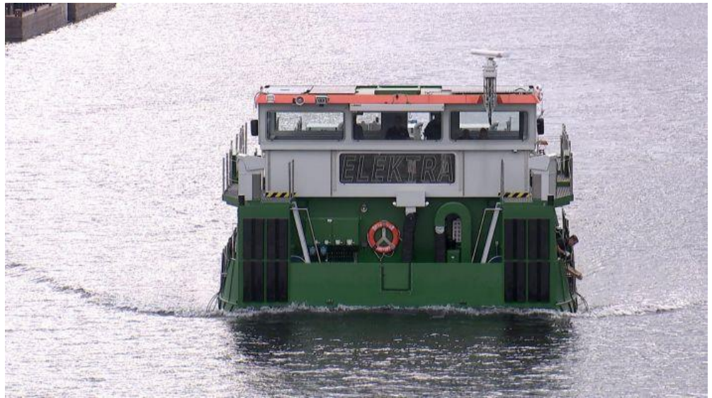
Bild: BEHALA; Schubboot ELEKTRA mit H2-Brennstoffzellen-Antrieb
